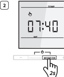
Der voreingestellte Bildschirmschoner ist die Bodentemperatur. Drücken und halten Sie die **MODE/OK** Taste für 2 Sek. Die Anzeige wechselt zur aktuellen Uhrzeit.
