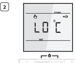
**LO °C** Anzeige für den Fall, dass die Heizung nicht in der Lage ist, den Boden um mehr als +5°C zu erwärmen.
