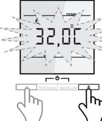
Die Bodentemperatur mit Hilfe der „+“ oder „-“ Taste einstellen.
