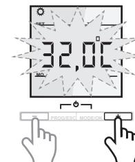
Stellen Sie die Temperatur, welche Sie während des COMFORT Temperaturprofils wünschen mit Hilfe der „+“ oder „-“ Tasten ein.
