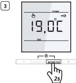
Wenn Sie die **MODE/OK** Taste erneut für 2 Sek. drücken, wechselt die Anzeige wieder zur Bodentemperatur.
