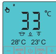
Wird die eingestellte maximale Raumtemperatur erreicht, wird die Heizung unabhängig von der Bodentemperatur abgeschaltet.
