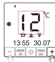
Die Frostschutztemperatur mit Hilfe der „+“ oder „-“ Taste einstellen.
