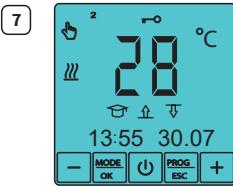
Bei Erstinbetriebnahme wechselt das Thermostat automatisch in den Modus „TEMPERATUR HALTEN“ und der dazugehörige Bildschirm wird angezeigt. Wenn das Thermostat bereits im Einsatz war und nur erneut eingeschaltet wird, wechselt die Anzeige zu dem Modus, der vor dem Ausschalten aktiv war.
