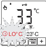
Anzeige im Fall eines BODENSENSORFEHLERS.
