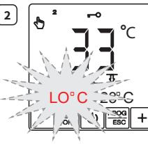
LO °C Anzeige für den Fall, dass die Heizung nicht in der Lage ist, den Boden um mehr als +5°C zu erwärmen.
