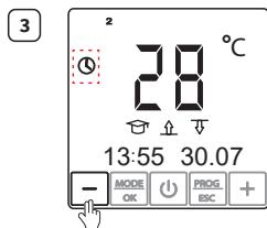
Wählen Sie den Programmzbetrieb mit Hilfe der „-“ Taste.
