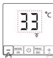
Stellen Sie die maximale Raumtemperatur mit Hilfe der „+“ oder „-“ Taste ein.
