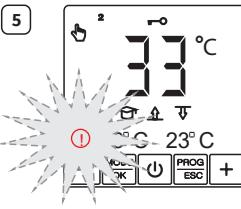
Die gewünschte Temperatur konnte über einen Zeitraum von 4 Stunden nicht erreicht werden - reduzieren Sie die Haltetemperatur.
