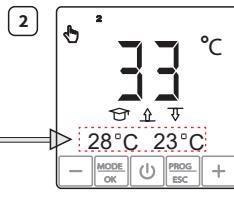
Um von der Uhrzeit-/Datumanzeige zur Anzeige der gemessenen Temperatur zu wechseln oder umgekehrt, drücken Sie 1x die EIN/AUS Taste.
