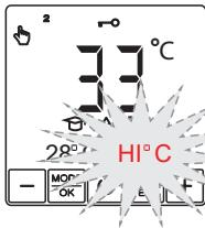
HI °C Anzeige für den Fall, dass eine Temperatur höher als +45°C erreicht wird.
