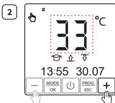
Die Haltetemperatur mit Hilfe der „+“ oder „-“ Taste einstellen.
