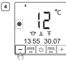
Wählen Sie den Frostschutz-Modus mit Hilfe der „-“ Taste.
