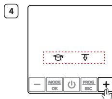
Deaktivieren/Aktivieren Sie den Bodensensor mit Hilfe der „+“ Taste.
