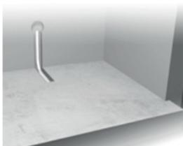
Vor dem Verlegen der Heizmatte auf dem Estrich, muss der Untergrund sauber, trocken, fest, staub- und schmutzfrei sein. Sollte der Unterbau uneben sein, so ist dieser vor der Verlegung der Heizelemente zu nivellieren, sodass Hohlräume unterhalb der Heizleitung vermieden werden. Bewegungsfugen in der Unterkonstruktion dürfen auf keinen Fall mit dem Flächenheizelement überbrückt werden.
