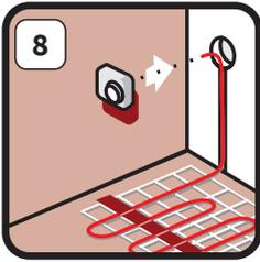
Schließen Sie den Heizkreis an das Thermostat an.
