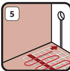
Verlegen Sie den Heizkreis entsprechend dem Verlegeplan. Wir empfehlen hierzu den Einsatz des 25mm Befestigungsbandes (siehe nachfolgendes Bild).
