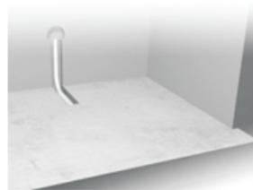
Vor dem Verlegen der Elektro-Comfort Dünnbettheizung auf dem Estrich muss der Untergrund sauber, trocken, fest, staub- und schmutzfrei sein. Sollte der Unterbau uneben sein, so ist dieser vor der Verlegung der Heizelemente zu nivellieren, sodass Hohlräume unterhalb der Heizleitung vermieden werden. Bewegungsfugen in der Unterkonstruktion dürfen auf keinen Fall mit dem Flächenheizelement überbrückt werden.
