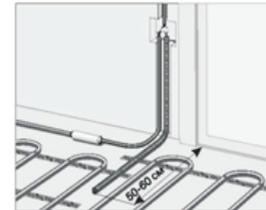
Der Bodenfühler sollte in der Mitte von zwei Heizleitungen verlegt werden. (Kaltleiter und Bodenfühler nicht im gleichen Rohr verlegen!). Verlegen Sie den Kaltleiter (Netzanschlussleitung) seitlich bis zur Anschlussdose. Der Kaltleiter darf den Heizleiter nicht kreuzen oder dauerhaft berühren! Halten Sie einen Mindestabstand von ca. 2 cm zu dem Heizleiter ein. Nachdem Sie die Verlegung abgeschlossen haben, messen
